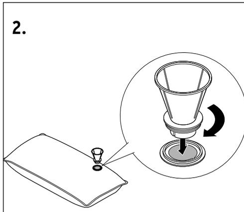
2. Pour verser l'eau, placez l'entonnoir sur le trou et vissez-le fermement.
